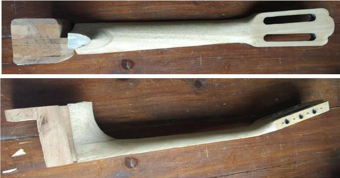
**Figura 3.5. Detalle del brazo despintado, lijado y con zoque incorporado.**
