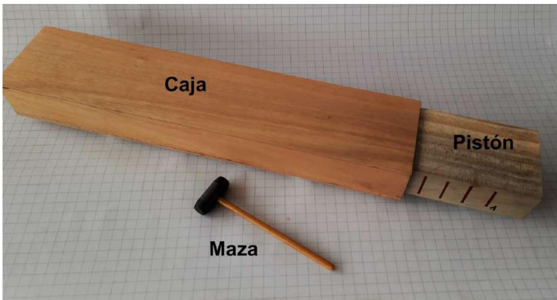
**Figura 4.21. Caja de madera de volumen ajustable mediante un pistón y maza con la cual la percutimos.**
