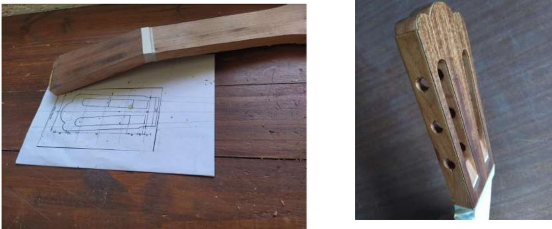
**Figura 3.27. Plano de perfil de cabeza Torres (izq.) y pieza terminada (der.).**
