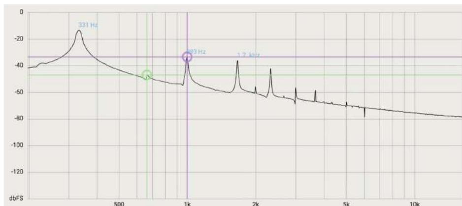
**Figura 1.7. Primeros armónicos del sonido emitido por una guitarra al pulsar una de sus cuerdas en el punto medio (obtenido con *Advanced Spectrum Analyzer PRO*)**
