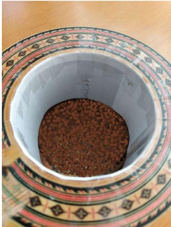
**Figura 4.54. Tornavoz fijado a la boca de una guitarra.**
