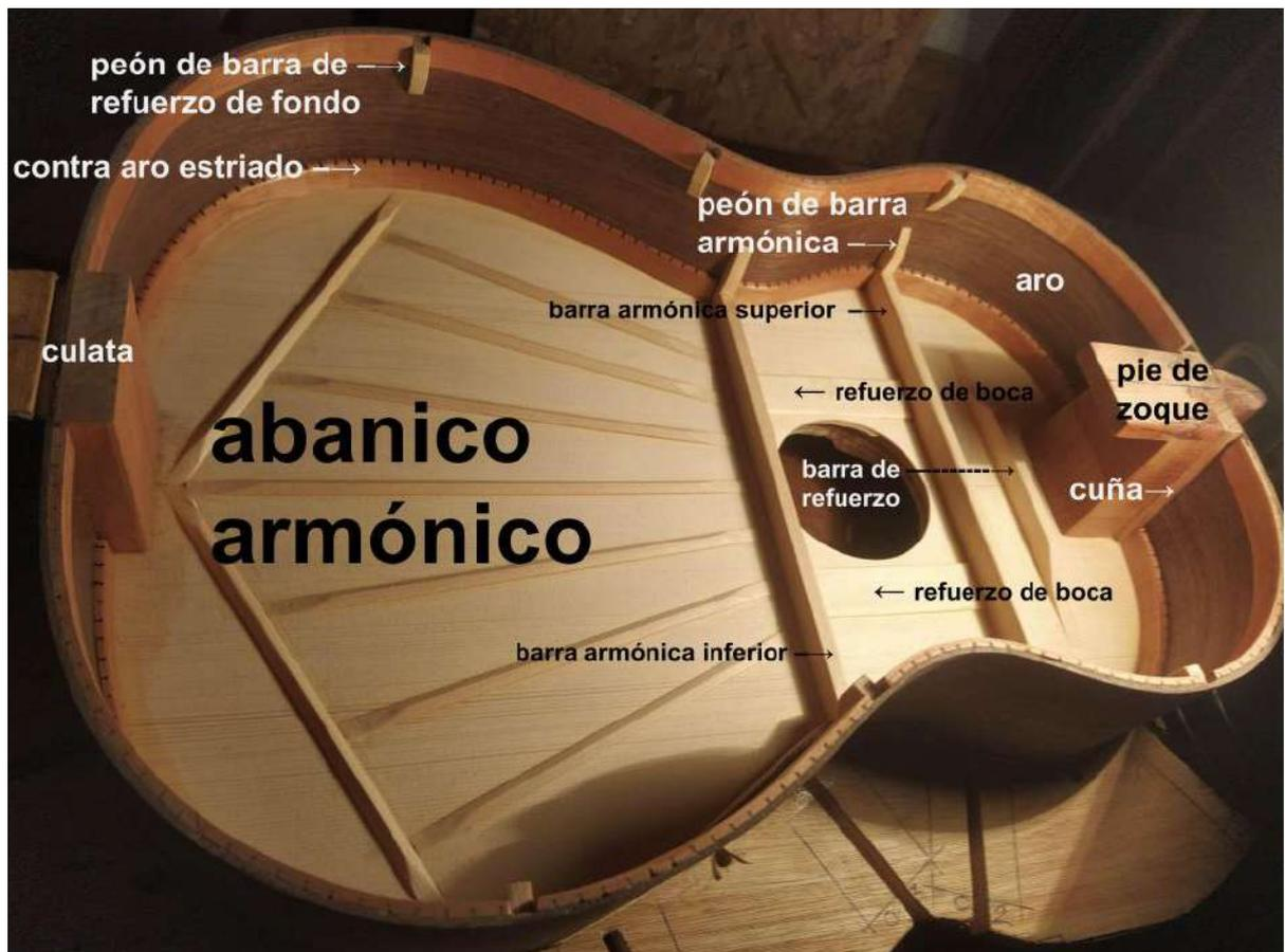
Figura 1.20. Detalle de parte de la estructura interna de la caja (tapa y aros).
