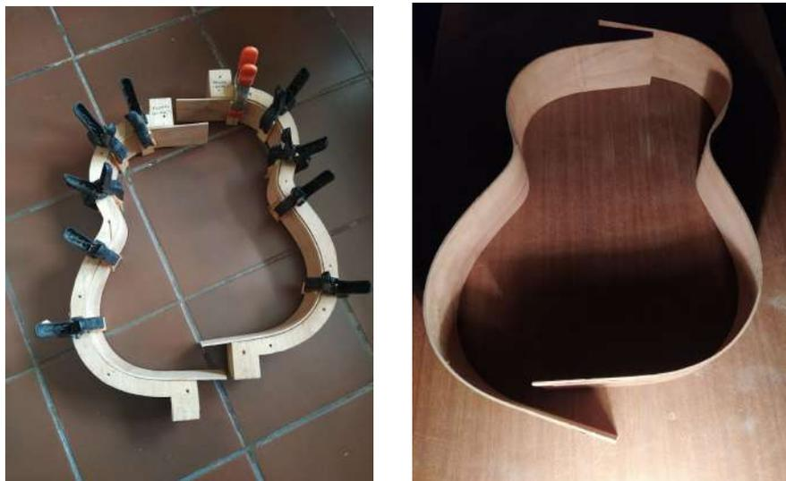
**Figura 3.29. Aros domados prensados a los moldes (izq.) y prontos (der.).**
