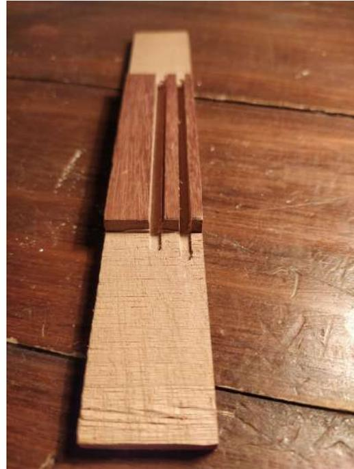
**Figura 3.17. Ranurado de canales del puente (izq.) y cortes iniciales (der.).**
