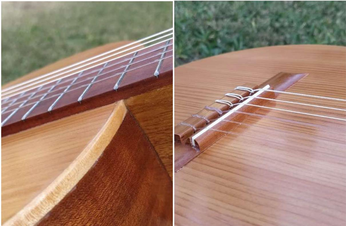
**Figura 3.22. Detalle de tapa, cenefa y aros (izq.) y puente (der.).**
