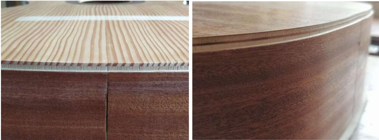
**Figura 3.33. Detalles de canal para cenefa de tapa (izq.) y fondo (der.).**
