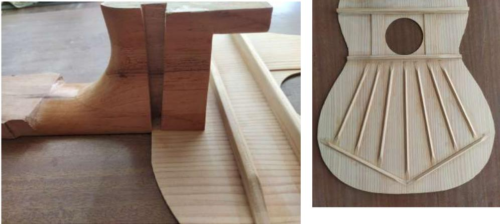
**Figura 3.28. Detalle de zoque (izq.) y tapa encolada al brazo (der.).**
