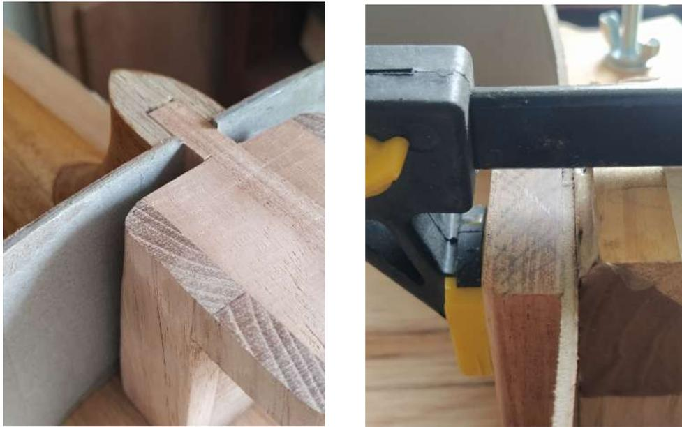
**Figura 3.9. Detalle de aros en ranuras del zoque (izq.). Encolado de culata a los aros (izq.).**
