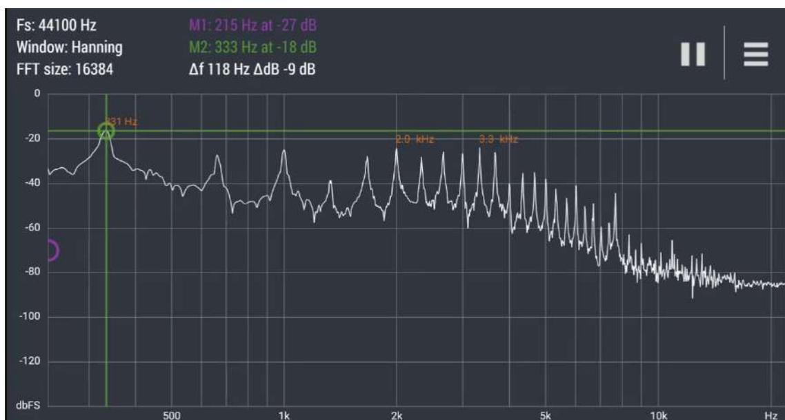
**Figura 4.68. Plano armónico de un sonido emitido al pulsar con púa la cuerda primera de una guitarra cerca del puente (captura de pantalla de *Advanced Spectrum Analyzer PRO*).**
