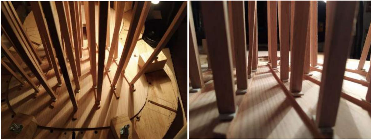
**Figura 3.24. Encolado de varetas del abanico a la tapa en Gobar sobre solera.**
