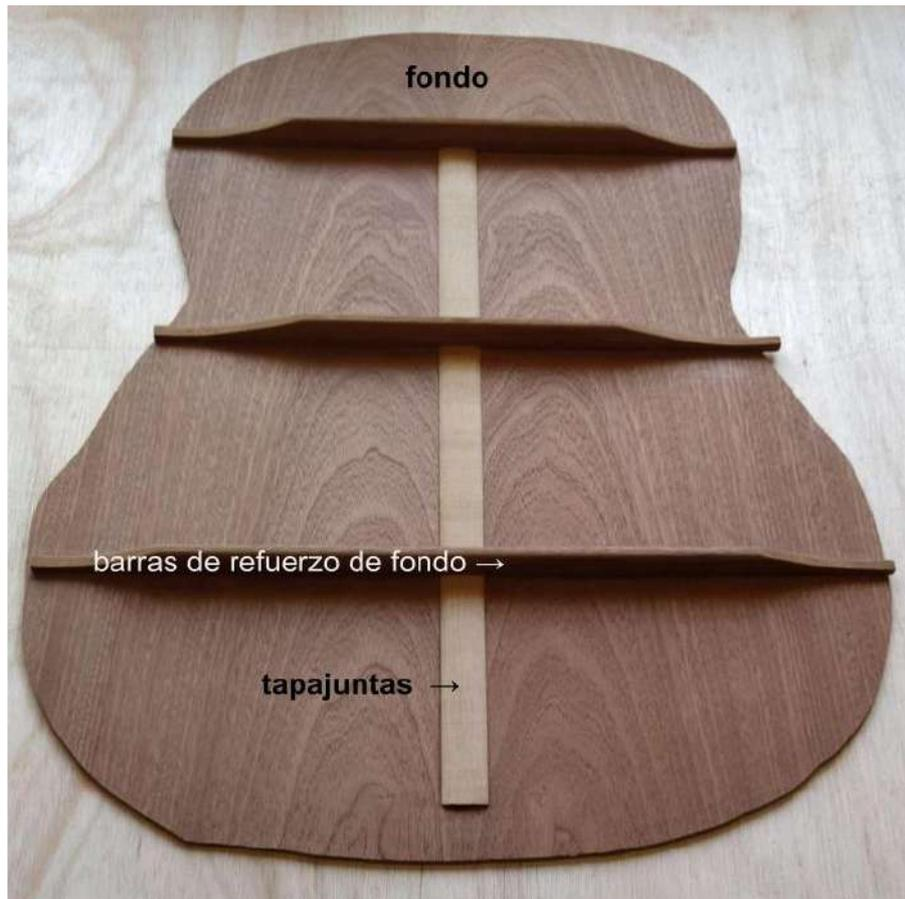
**Figura 1.21. Detalle de la estructura interna del fondo.**
