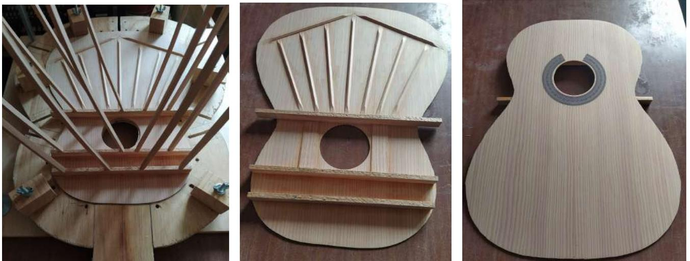
**Figura 3.25. Encolado de barras armónicas a la tapa (izq.), tapa con varetaje sin terminar (centro) y tapa con roseta incrustada (der.).**
