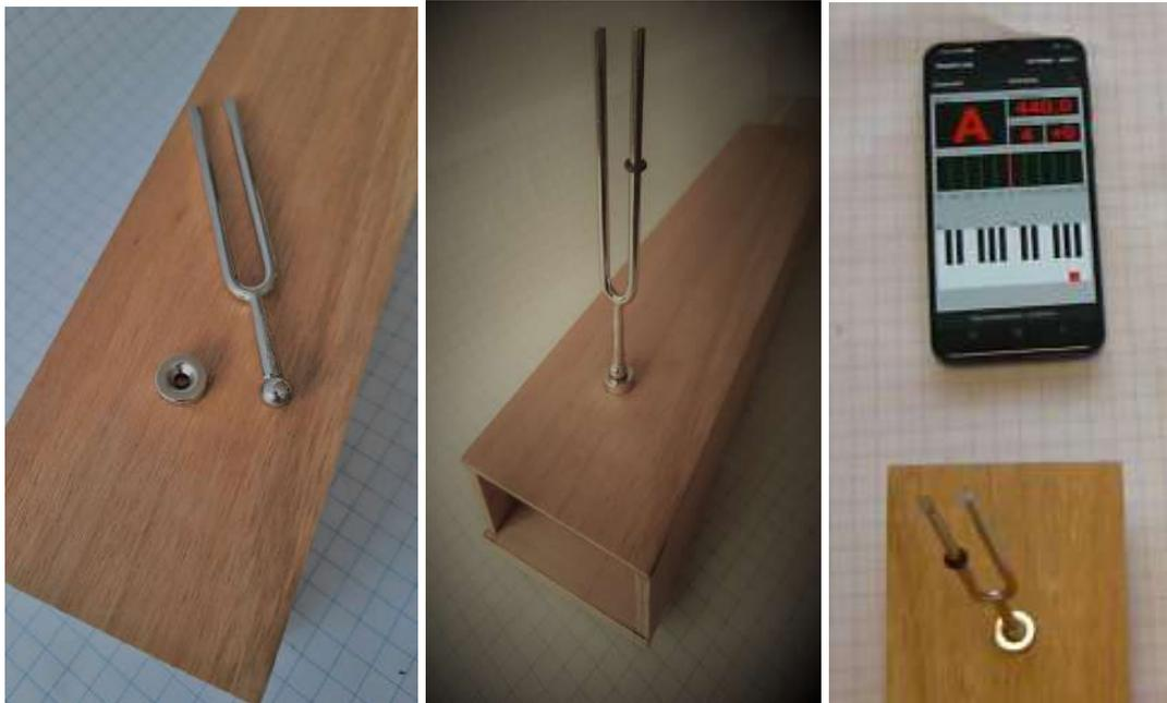
**Figura 4.28. Diapasón con su caja de profundidad variable.**
