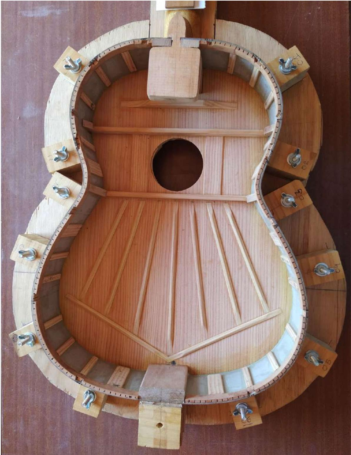
**Figura 3.10. Montaje de tapa y brazo a los aros sobre la solera.**
