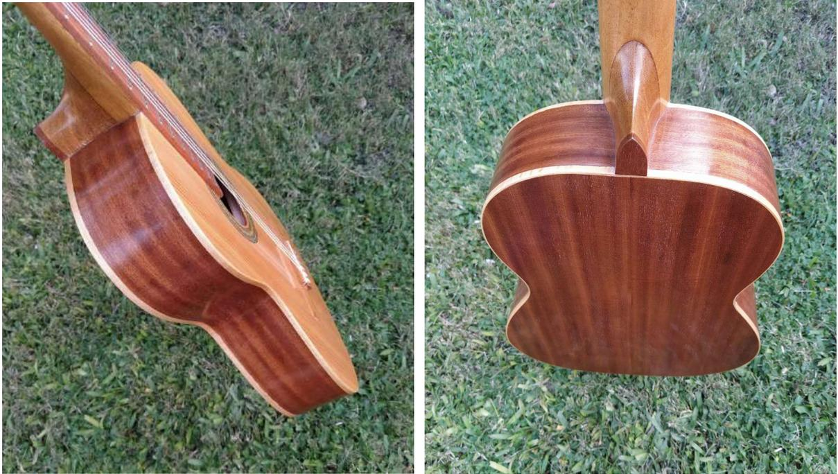
**Figura 3.21. Detalle de aros, tapa y talón (izq.) y aros, talón y fondo (der.).**
