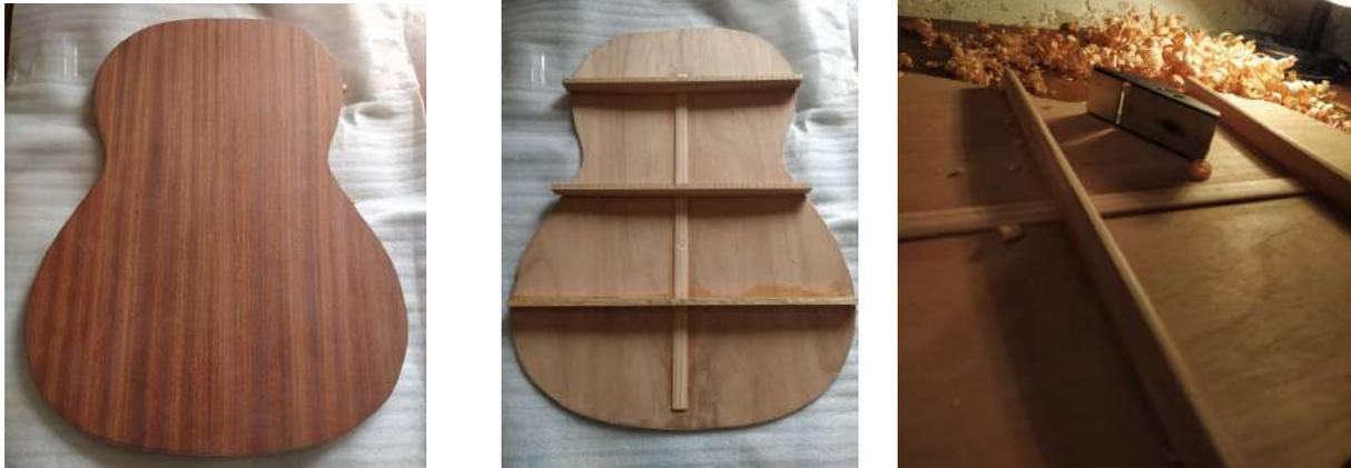
**Figura 3.32. Fondo de frente (izq.), tapajuntas y barras de refuerzo en bruto (centro) y barras de refuerzo en proceso de tallado (der.).**
