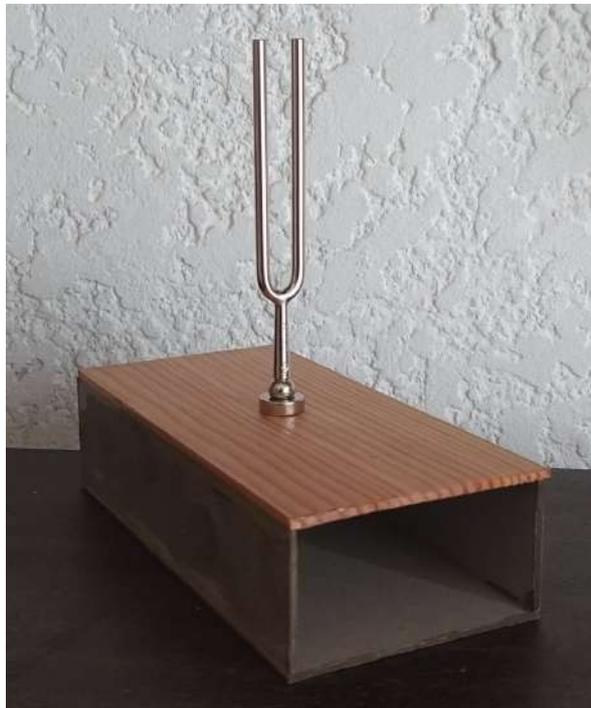
**Figura 4.43. Diapasón con una caja de resonancia construida con madera y cartón gris.**
