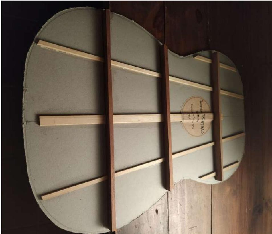
**Figura 3.13. Fondo con varillas diagonales, tapajuntas, barras de refuerzo y etiqueta.**
