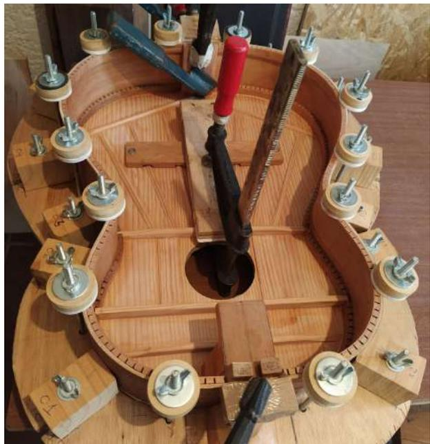
**Figura 3.31. Montaje de tapa, aros y culata sobre solera.**
