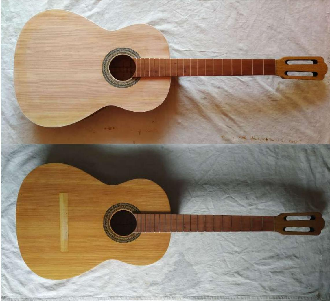
**Figura 3.16. Instrumento en etapas de lijado (arriba) y acabado pulido francés (abajo).**
