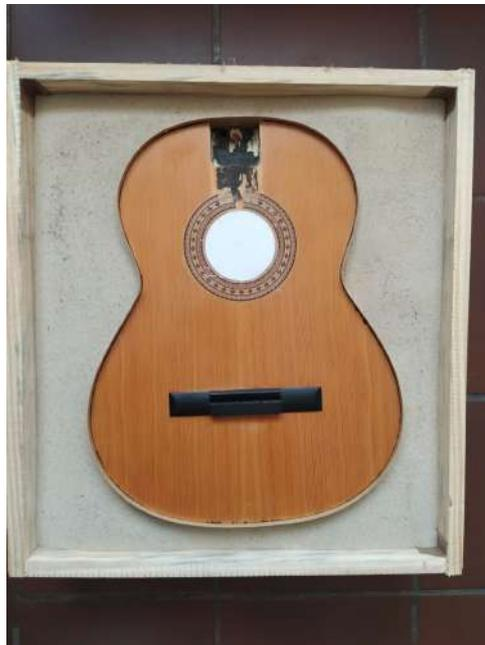
**Figura 4.50. Caja de guitarra con su boca tapada inmersa en una caja con arena.**
