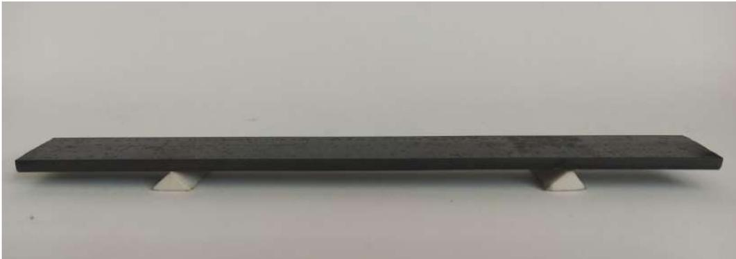
**Figura 4.5. Montaje de la planchuela mediante dos trozos de goma ubicados en los nodos del modo fundamental.**
