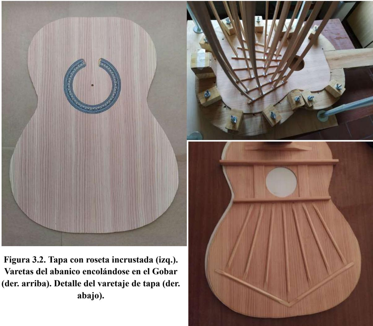
**Figura 3.2. Tapa con roseta incrustada (izq.). Varetas del abanico encolándose en el Gobar (der. arriba). Detalle del varetaje de tapa (der. abajo).**
