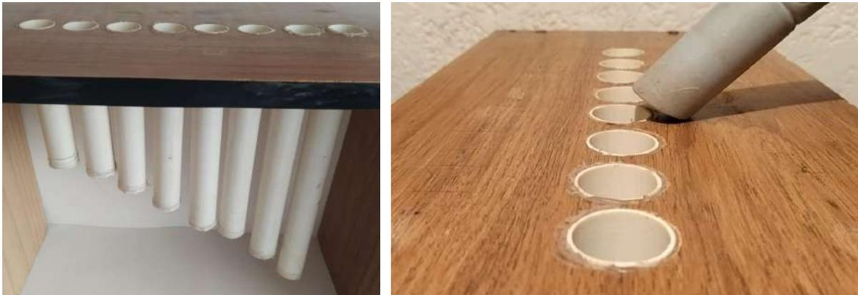
Figura 4.31. Tubos montados sobre orificios de una placa de madera (a) y el extremo de una “sopladora” sobre la boca de uno de ellos (b).
