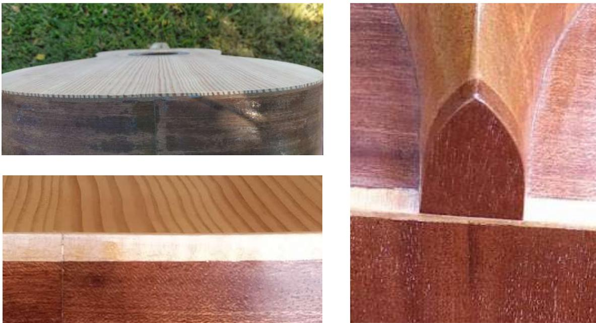
**Figura 3.14. Detalle del borde de la tapa enrasado a los aros (izq. arriba) y con la cenefa encolada en el canal realizado previamente con router (izq. abajo). Tapa de talón (der.).**
