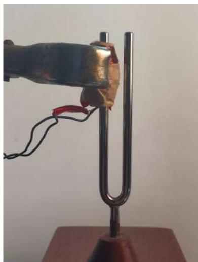
**Figura 4.29. Diapasón montado en su caja excitado por la bobina alimentada con la señal amplificada de un oscilador.**
