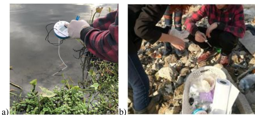
Figura 1. a) Toma de medida de pH con sensor físico-químico del Plan Ceibal en la estación 3. b) Colocando reactivos fijadores en la muestra de oxígeno disuelto en la estación 4. Fuente: elaboración propia.
