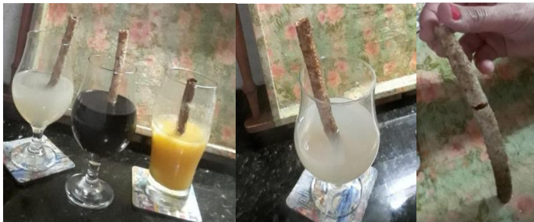
Figura 9. Final del testeo. En la imagen izquierda y central se muestra los sorbitos comestibles salados en las bebidas a los 40 y 60 minutos respectivamente. A la derecha se muestra un sorbito en el minuto 65. Fuente: elaboración propia.
